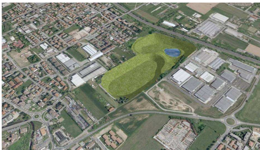
Figura 9 – Invaso laminazione in scavo a Varedo
